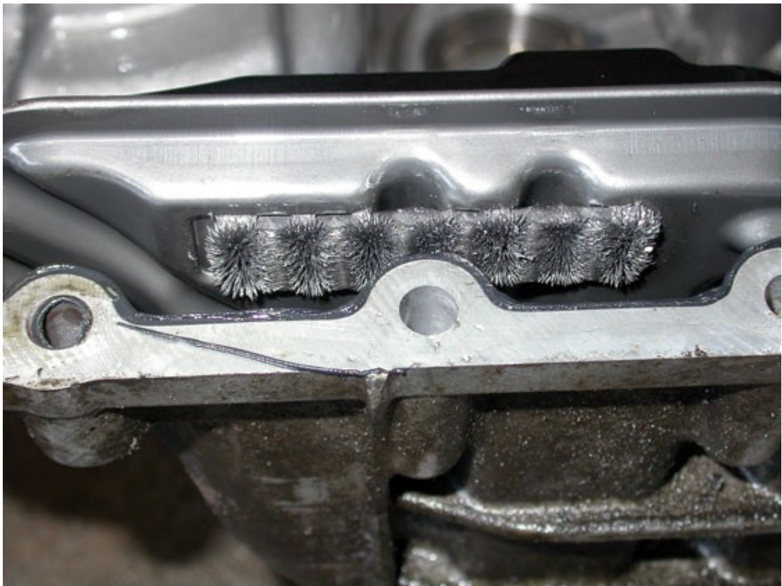
Штатный магнитный уловитель, специально предназначенный для сбора продуктов износа
