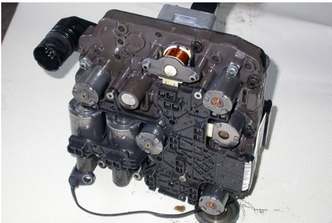
В Mechatronik встроено 12 датчиков, 8 гидроцилиндров, 6 клапанов регуляторов давления и 5 клапанов переключения передач
