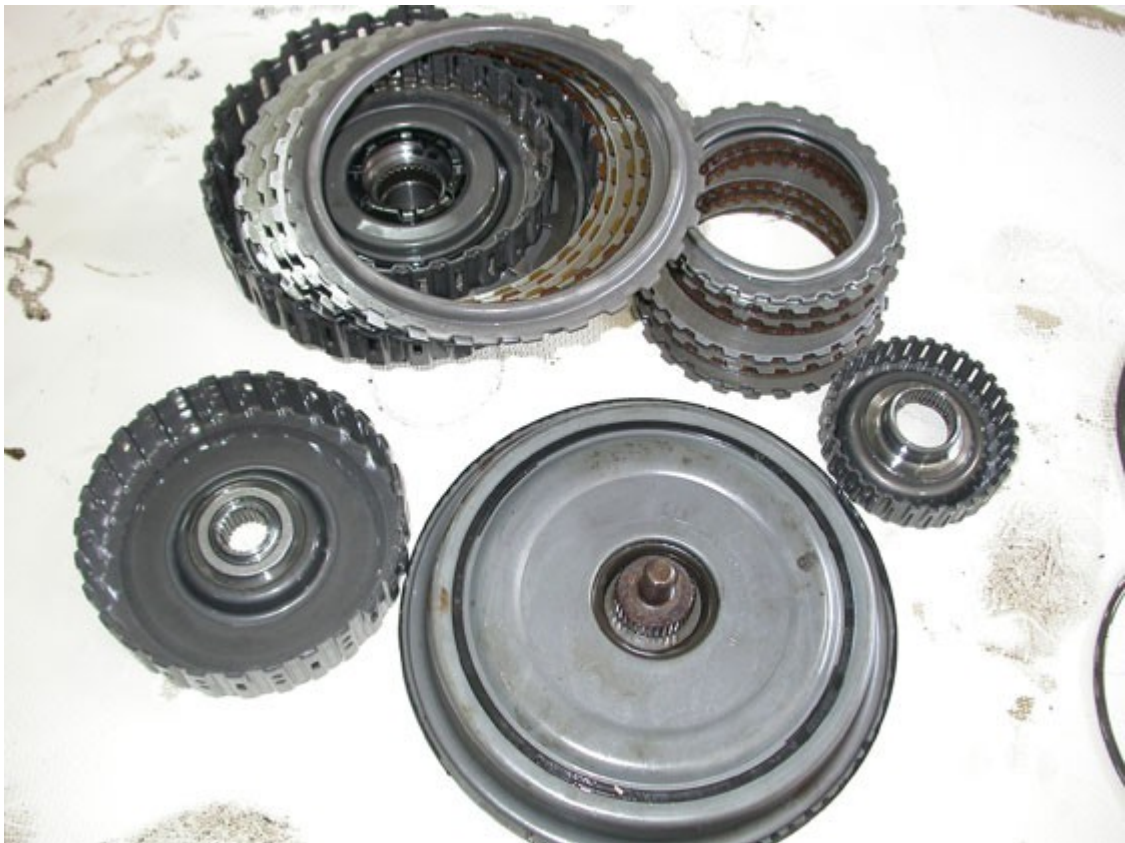
На 6-ступенчатых DSG, дебютировавших в 2003 году, сцепления многодисковые "мокрые" - пакеты дисков работают в масле, которое и смазывает их, и охлаждает
