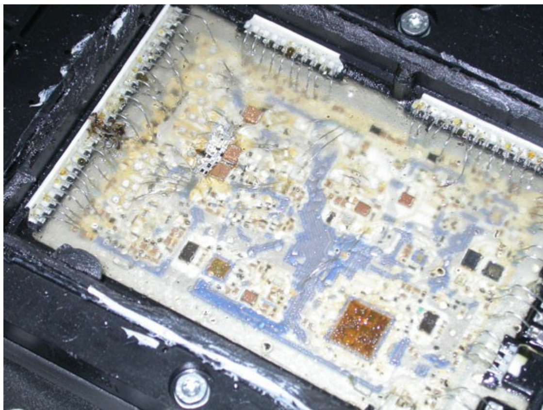
Пятно нагара на электронной плате блока управления указывает место, где обломался проводок
