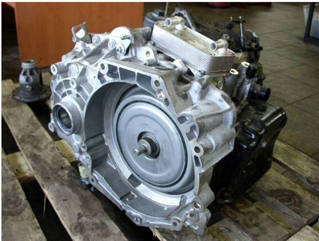
На корпусе коробки сверху имеется водомасляный теплообменник, "привязанный" к системе охлаждения двигателя
