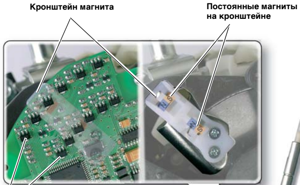
Датчики Холла для определения положений селектора P, R, N, D и S
