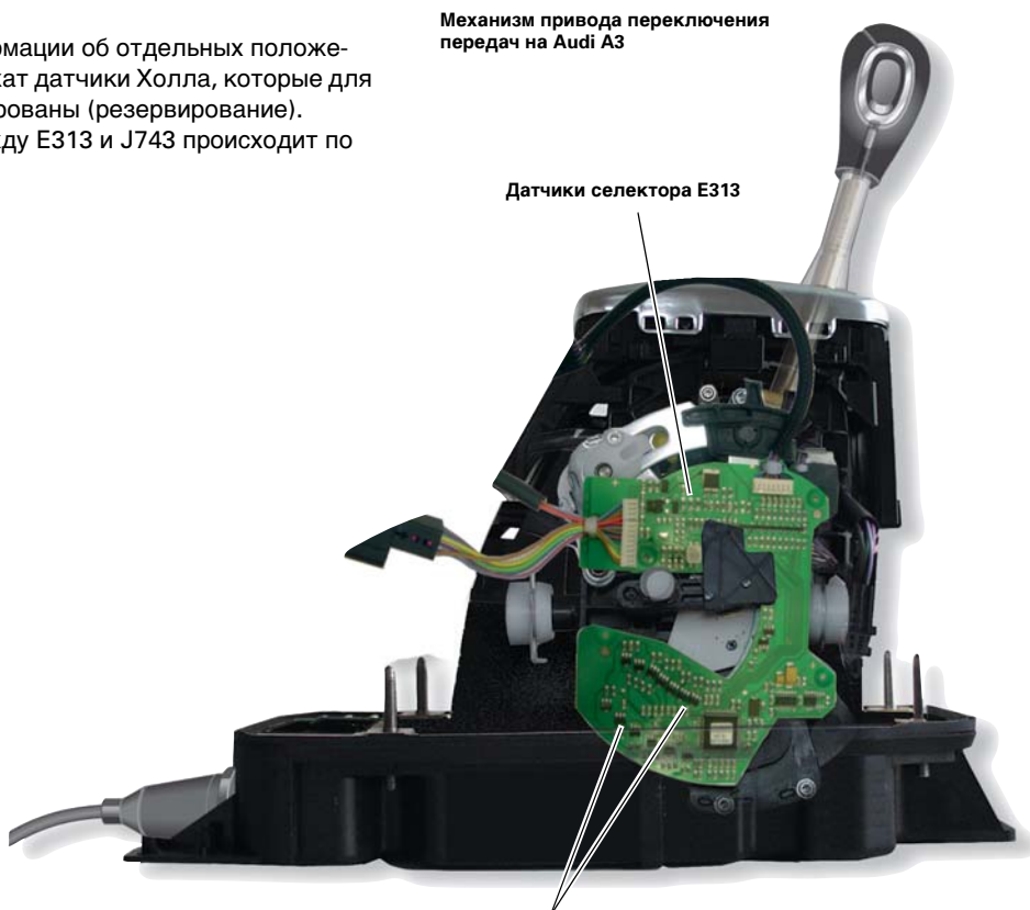
Датчики Холла для определения положений селектора P, R, N, D и S
